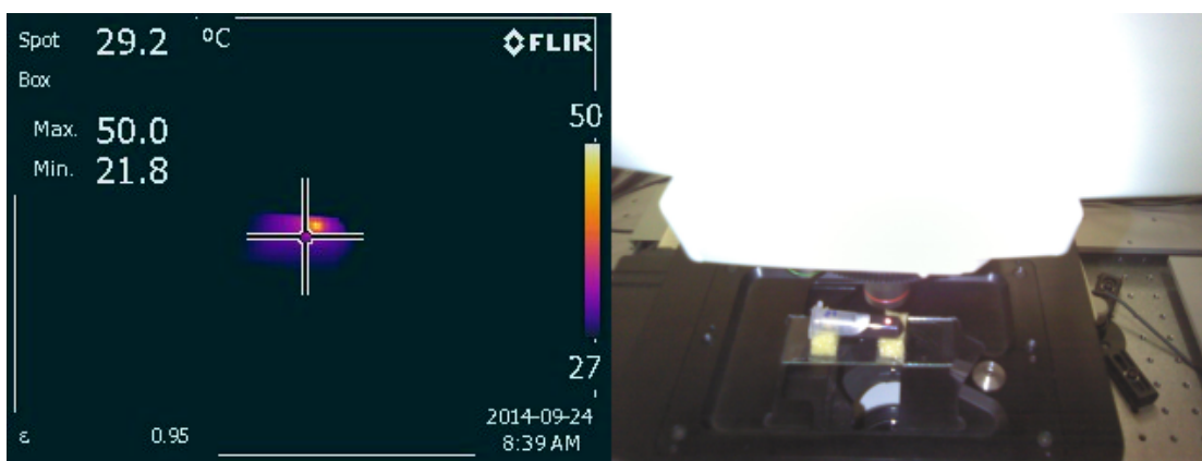
Fig. II.3.10. Răspunsul fototermic a NPAs120 învelite cu heparină la iradierea lor cu laserul 785nm.
